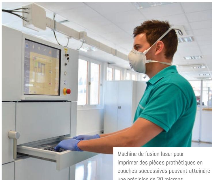
Machine de fusion laser pour imprimer des pièces prothétiques en couches successives pouvant atteindre une précision de 30 microns.
